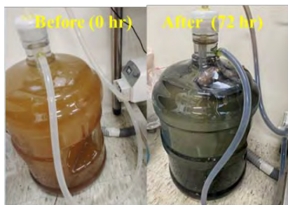
圖一 添加廢豬血之生物反應槽初期與後期顏色變化，藍黑色為硫化亞鐵固體
