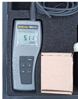
圖二 現地測量水質數據之設備
